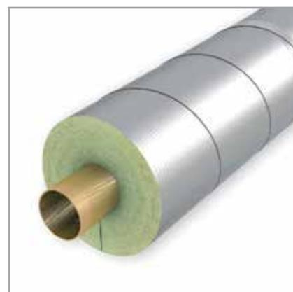
Герметичный продольный стык цилиндров PAROC Hvac Section AluCoat T предотвращает попадание водяных паров из окружающей среды на поверхность холодных труб, не допуская тем самым выпадения на них конденсата влаги.
