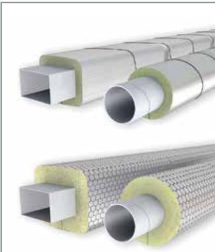
*Технические маты с покрытием из алюминиевой фольги, ламельные маты, а также прошивные маты устанавливаются на воздуховодах при помощи алюминиевой клейкой ленты, стальной проволоки, шпилек и фиксирующих шайб.*
