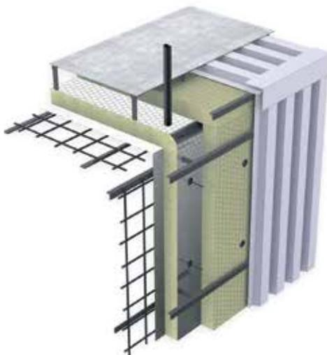
При проведении работ по изоляции котлов необходимо учитывать тепловое расширение всех элементов конструкции. Изоляция экранов котлов закрепляется на шпильках, приваренных к трубным плавникам.
