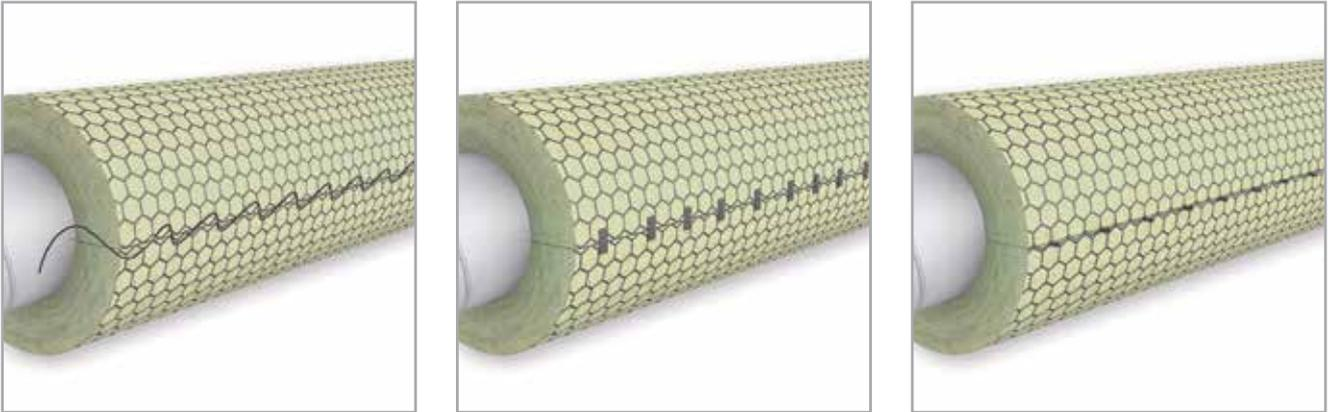
Огнезащитное покрытие – мат из минеральной ваты – оборачивается вокруг воздуховода и за счет имеющейся на его поверхности сетки, а так же с помощью вязальной проволоки стягивается и прошивается. Желательно этот шов делать в верхней части воздуховода. Шов должен быть плотным без разрывов в покрытии, возможно даже делать стык матов внахлест.
